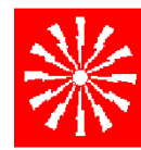
PULSANTE DI ALLARME ANTINCENDIO
